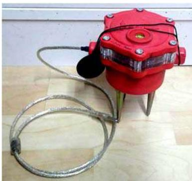
Figura 18 – Tromografo 3D a 4,5Hz.
